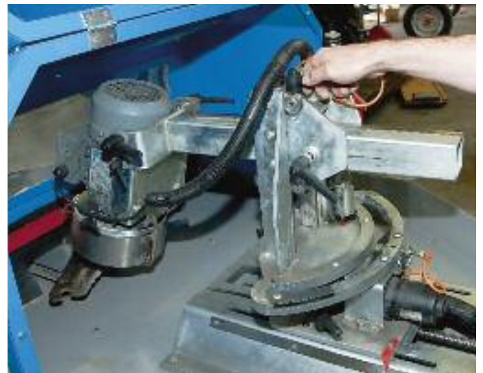
Durch ein Verschieben des Arms wird dessen Bogendurchmesser an den Bogen des Messers angepasst.
