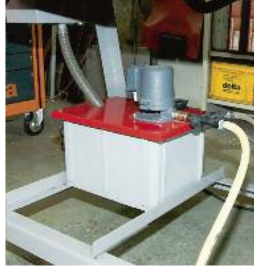
Die Kühlflüssigkeit befindet sich in diesem Behälter unter der Maschine.
