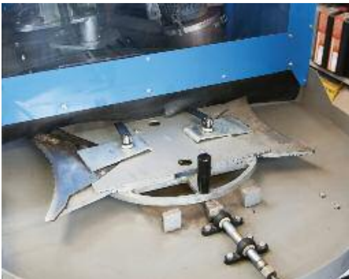
Für jeden Messertyp benötigt man eine genau passende Schablone, die auf einer Art Drehtisch befestigt wird.
