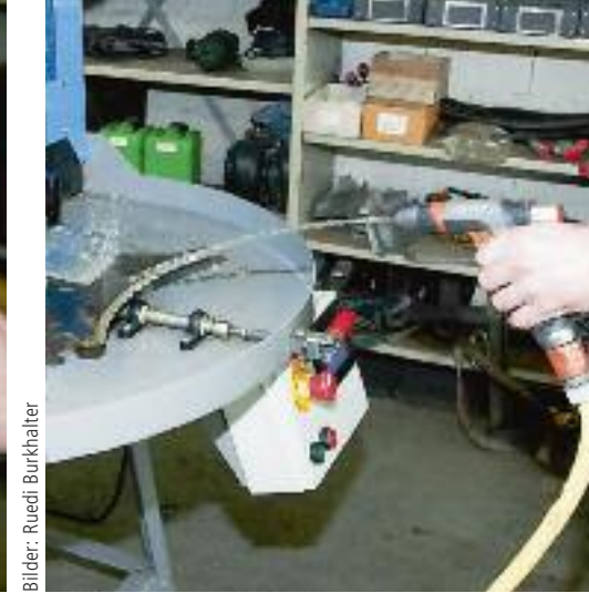
Nach dem Schärfen kann man den Abrieb mit einer Spritzpistole abspülen.
