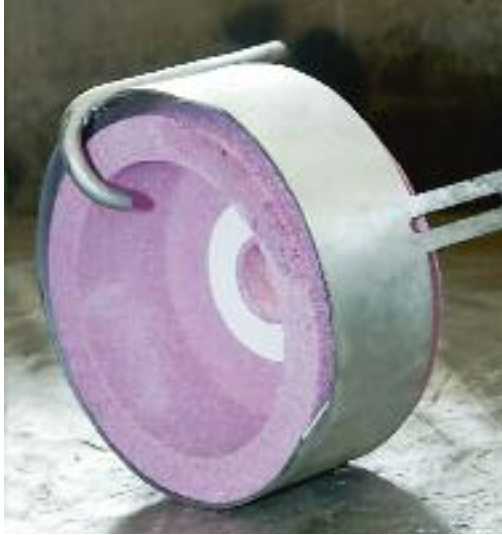
Die Kühlflüssigkeit wird über einen Rohrbogen unter den Schleifstein gefördert.
