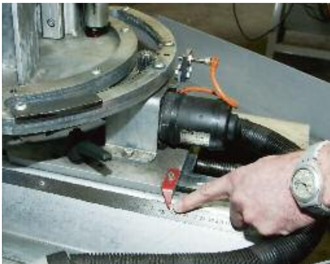
Die Position des Drehpunkts wird, abhängig von der Art des Messers, hinter dem Gehäuse an einer Spindel eingestellt.
