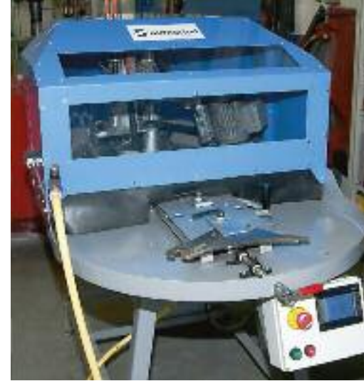
Während ein Messer im Gehäuse geschärft wird, kann man bereits das nächste fixieren.
