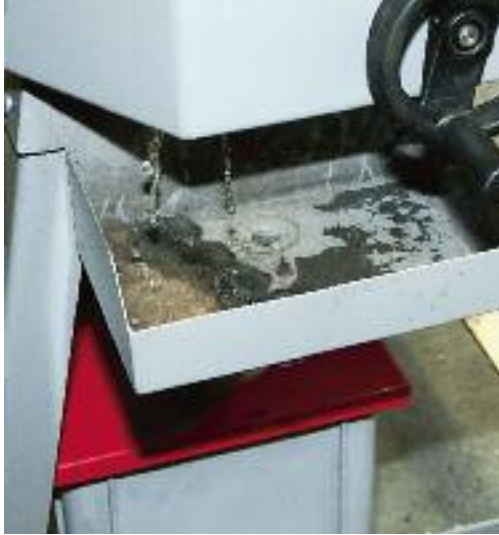
In diesem magnetischen Trennbecken wird der Metallabrieb zurückgehalten.
